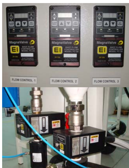
Slika 5: Magnetni ventili in krmilniki za regulacijo medija
