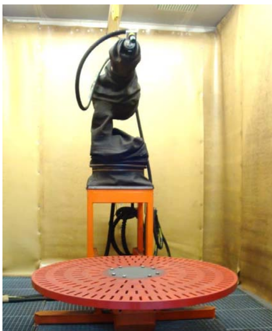
Slika 3: Zaščita robota in notranjosti celice
